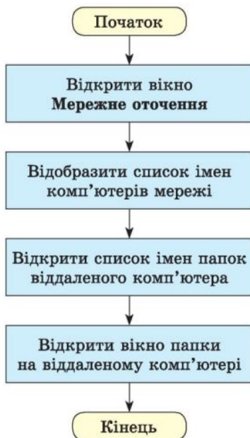
Рис. 5.8. Блок-схема алгоритму здійснення навігації локальною мережею
