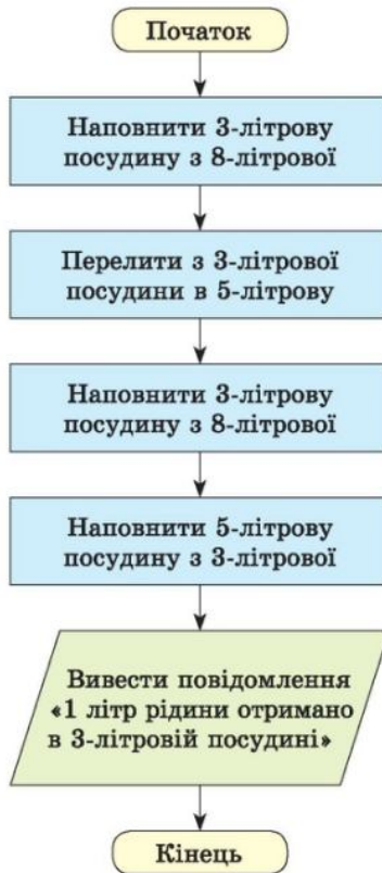
Рис. 1.19. Блок-схема алгоритму отримання 1-го літра рідини
