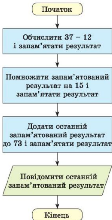
Рис. 1.20. Блок-схема алгоритму обчислення значення виразу 73 + (37 - 12) \cdot 15
